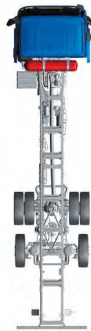
CNG - hinter der Kabine
