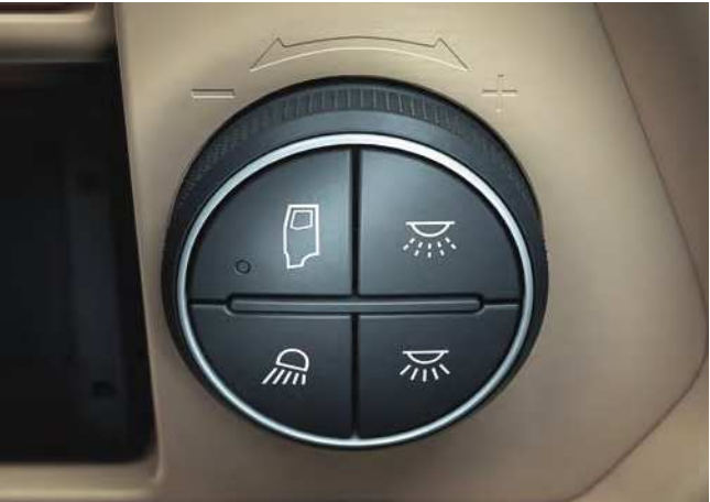
Mit dem Drehschalter steuern Sie bequem mit einer Hand alle Lichteinstellungen und die Dimmer-Funktion.
